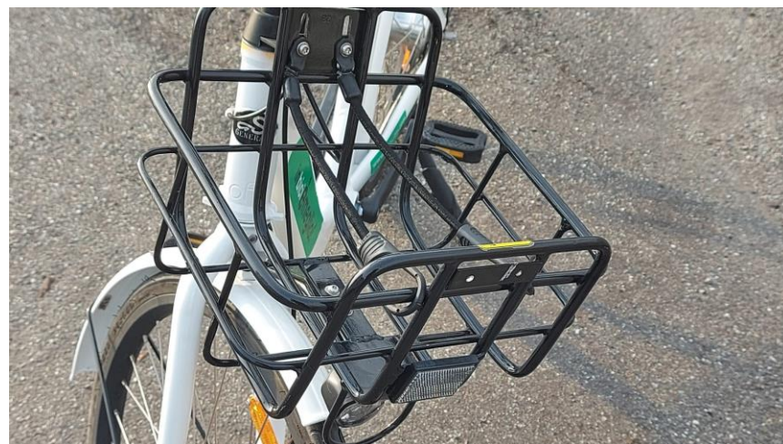
Cestino metallico integrato con cavi elastici di tenuta, leve freno con protezione meccanica antivandalica del cavo
