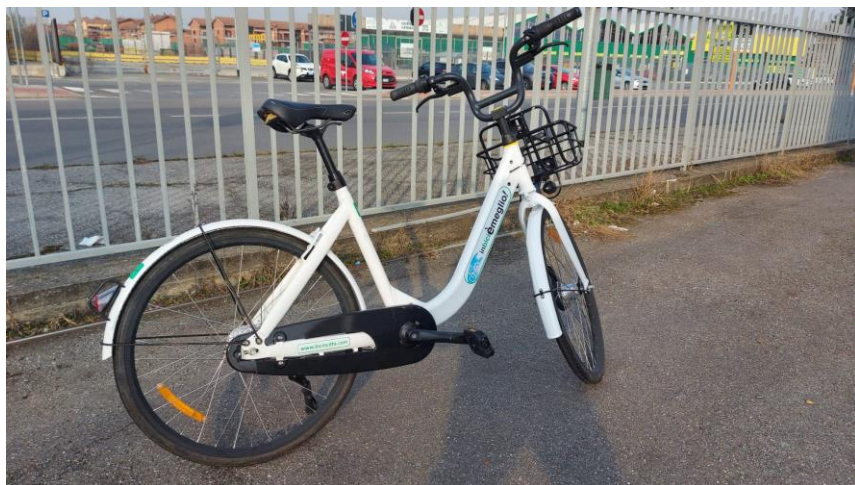
Carter catena interamente in metallo, impianto luci anteriore e posteriore a led protette da griglia metallica
