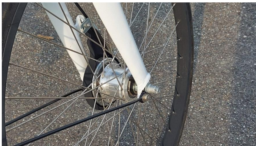
Dinamo automatica nel mozzo, freni anteriore e posteriore a tamburo a espansione, copertoni antiforatura in gomma piena
