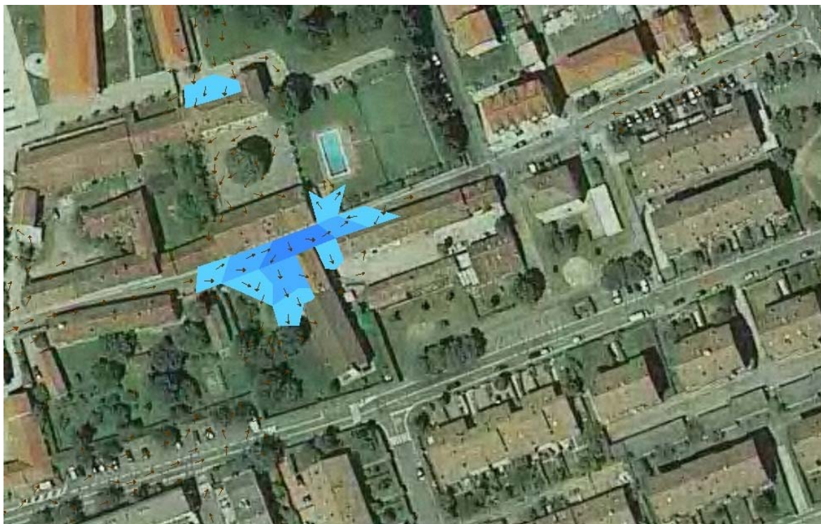
Figura 7.6 – Allagamenti >5cm in via Sorigherio a Poasco, risolvibili con interventi non strutturali
