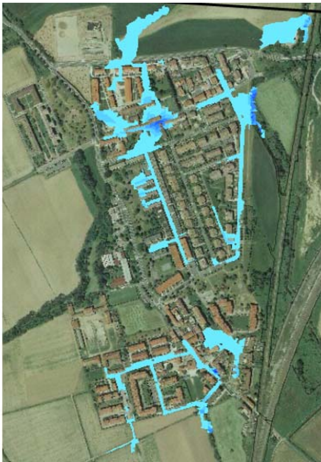
Figura 6.42 - Allagamenti stato di fatto T50 San Donato Ovest
