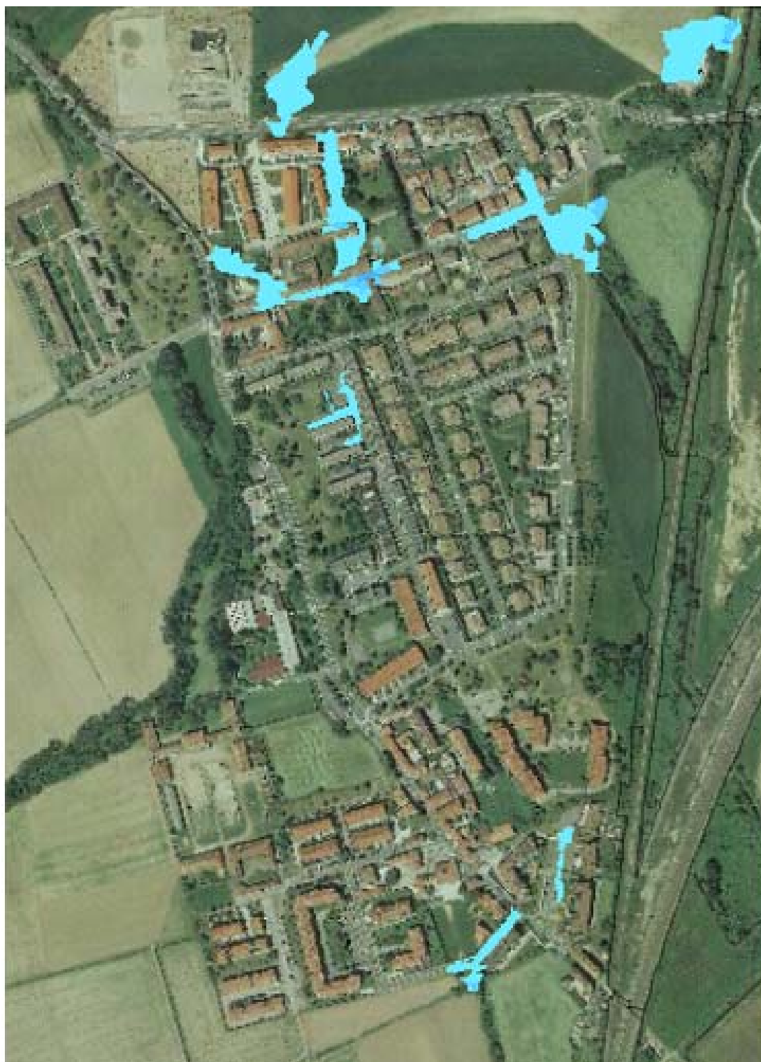
Figura 6.40 - Allagamenti stato di fatto T5 San Donato Ovest
