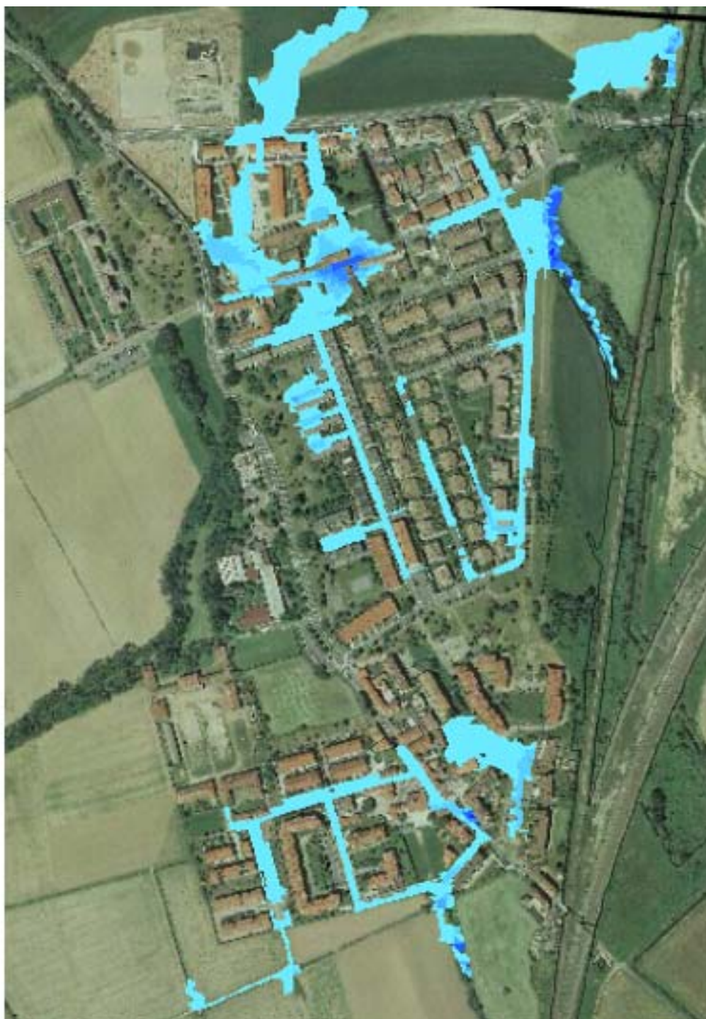
Figura 6.43 - Allagamenti stato di fatto T100 San Donato Ovest
