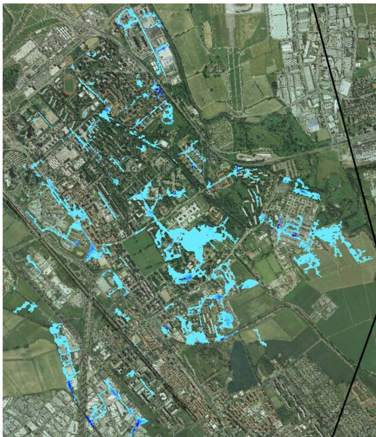
Figura 6.37 - Allagamenti stato di fatto T50 San Donato Est
