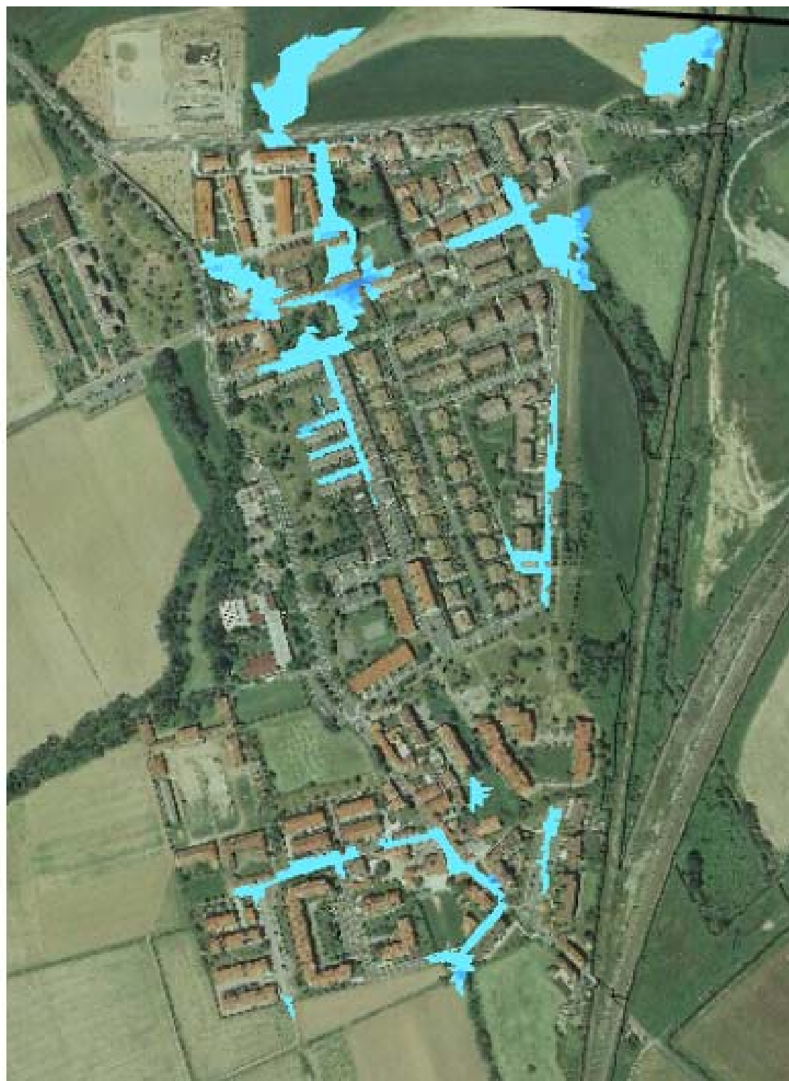
Figura 6.41 - Allagamenti stato di fatto T10 San Donato Ovest
