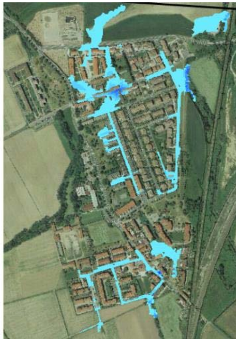
Figura 7.29 – Allagamenti stato di fatto T50 San Donato Ovest
