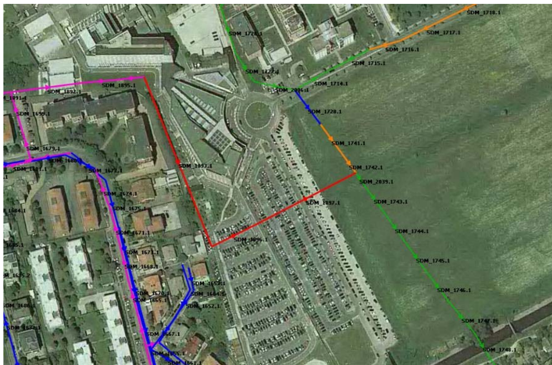
Figura 8.21 – Riduzione allagamenti per T=10 anni sulla dorsale centrale nella zona dell'ospedale
