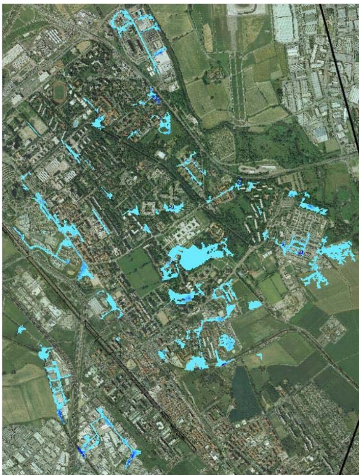
Figura 7.23 – Allagamenti stato di fatto T10 San Donato Est
