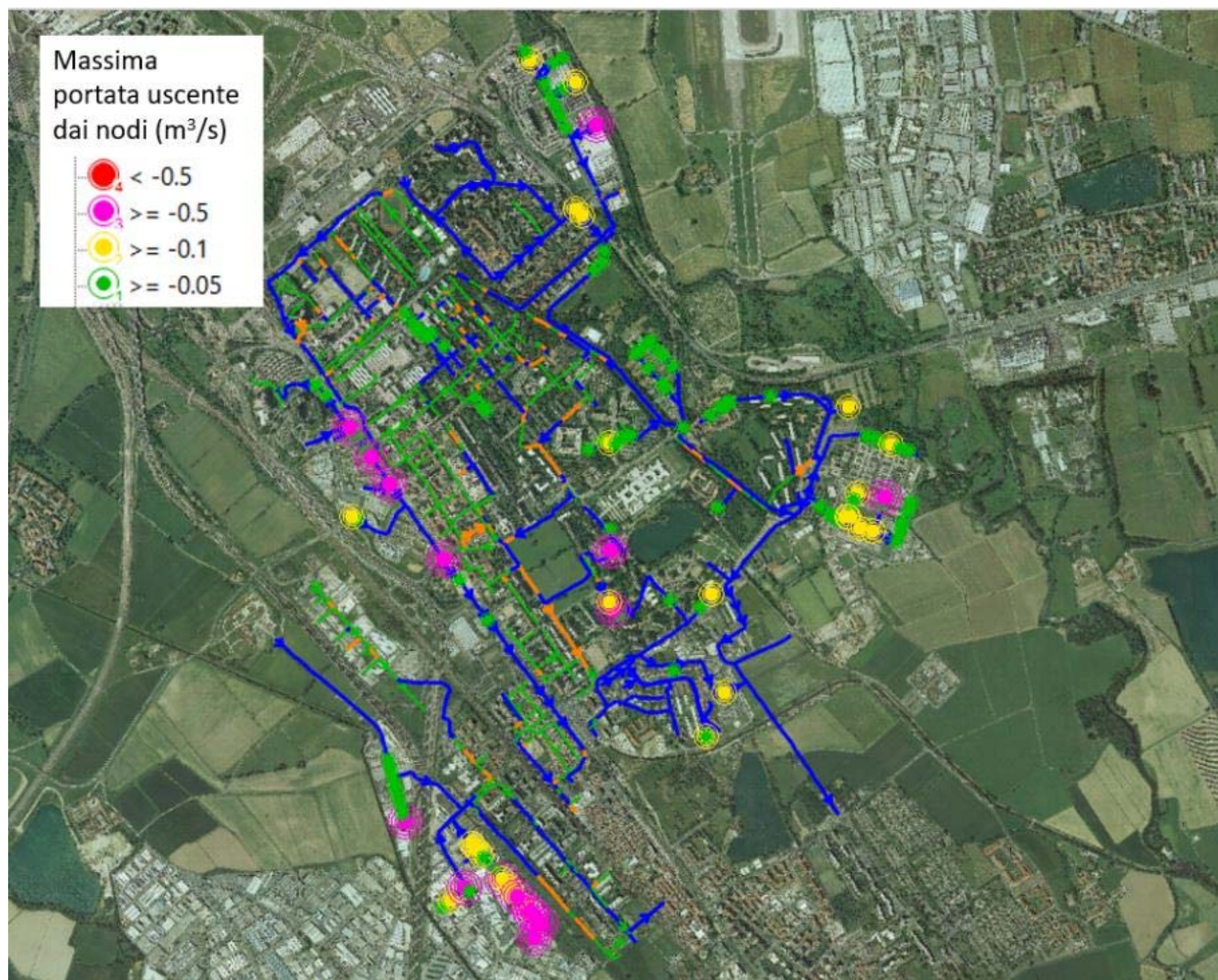
Figura 7.11 – Portata massima uscente dai nodi T2 San Donato Est
