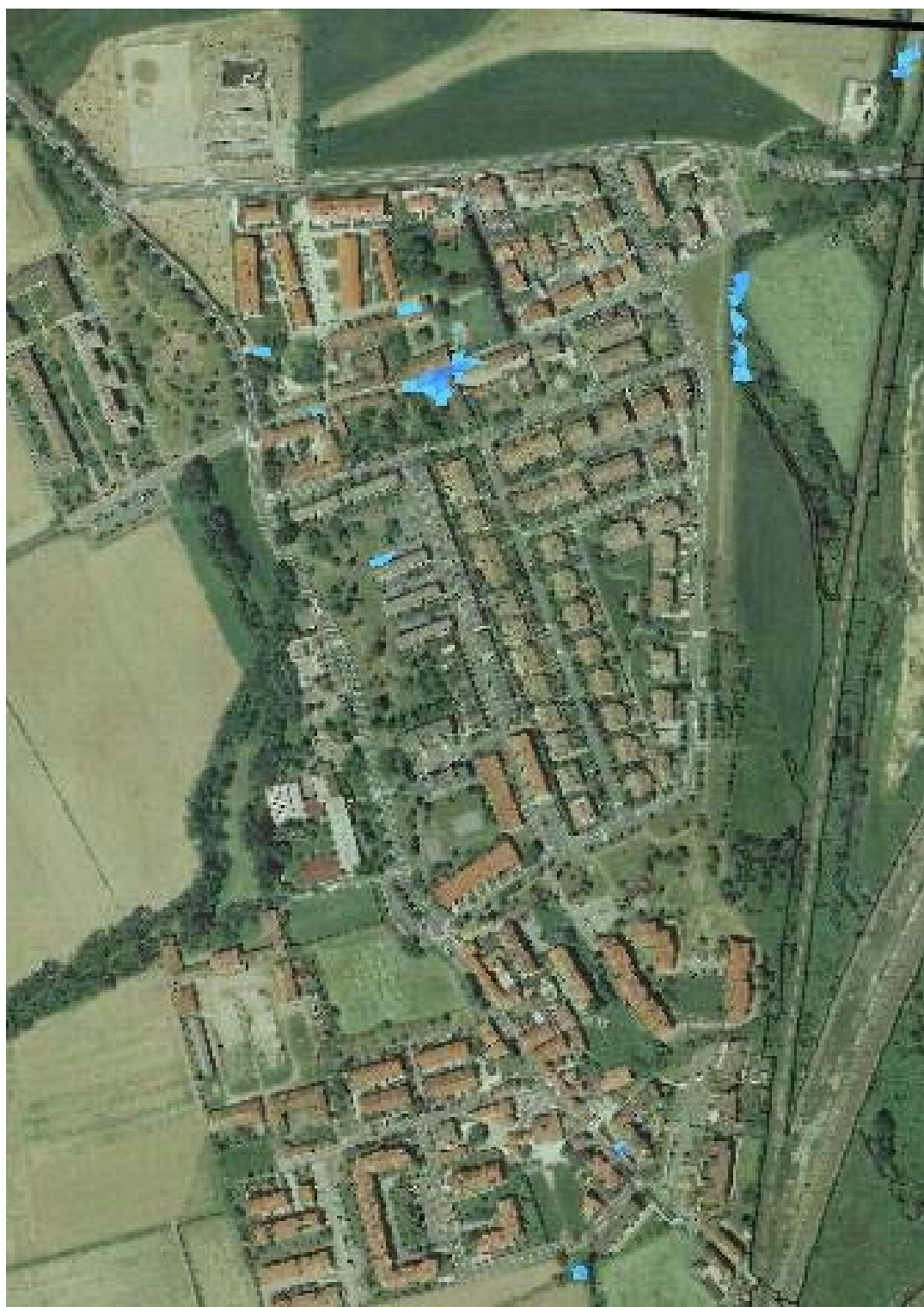
Figura 7.36 – Allagamenti stato di fatto per T=10 anni San Donato Ovest con tiranti maggiori di 5 cm
