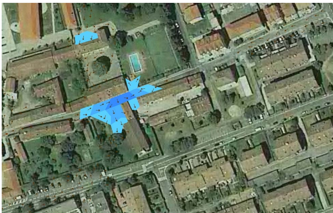
Figura 8.47 – Allagamenti >5cm in via Sorigherio a Poasco, risolvibili con interventi non strutturali
