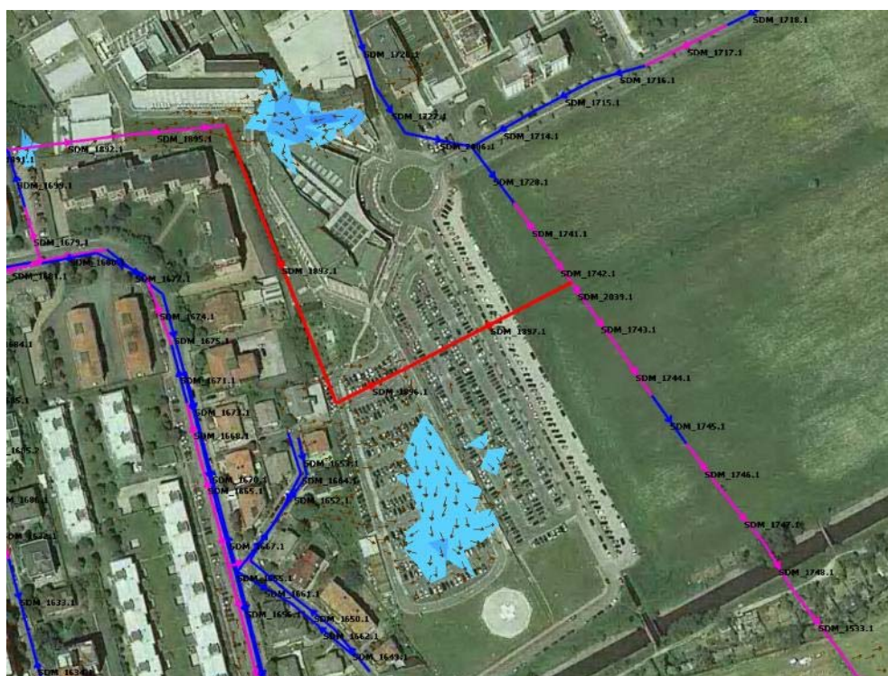
Figura 8.19 – Allagamenti stato di fatto per T=10 anni sulla dorsale centrale nella zona dell'ospedale
