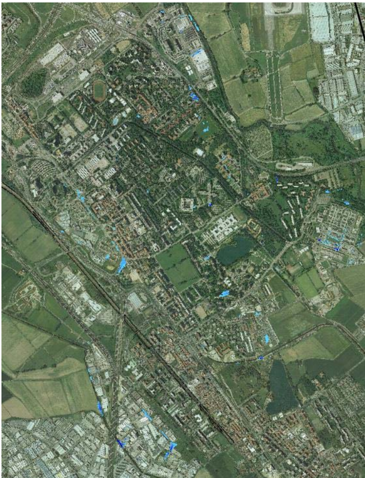
Figura 8.25 – planimetria degli allagamenti T=5 anni stato di fatto
