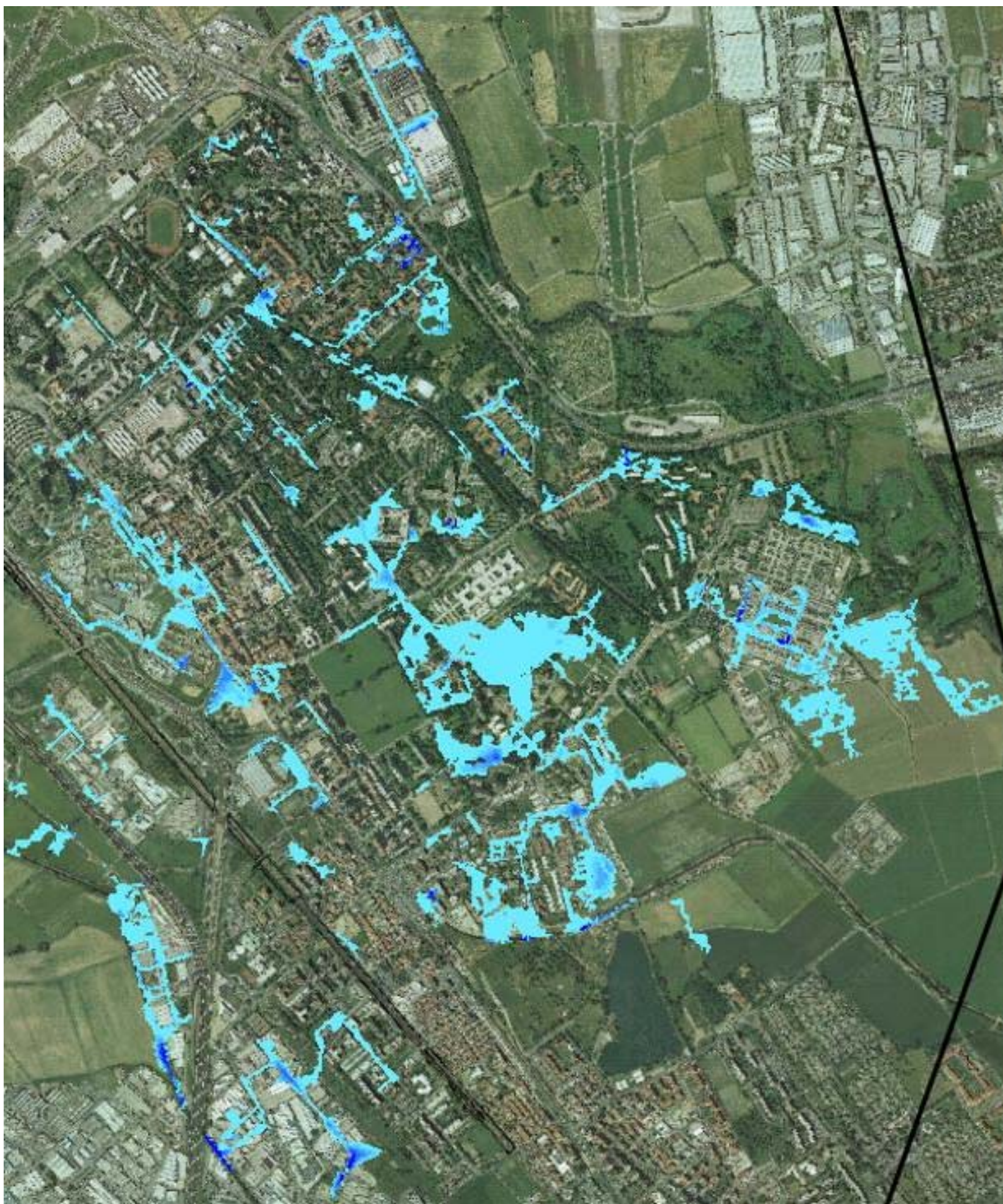
Figura 8.31 – planimetria degli allagamenti T=100 anni stato di fatto
