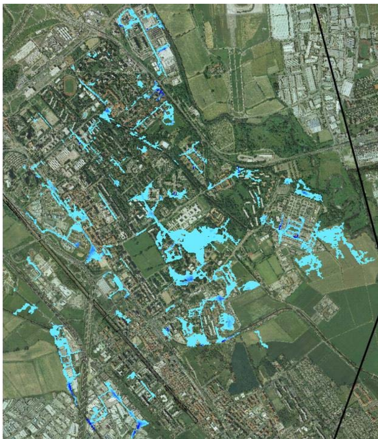
Figura 7.24 – Allagamenti stato di fatto T50 San Donato Est
