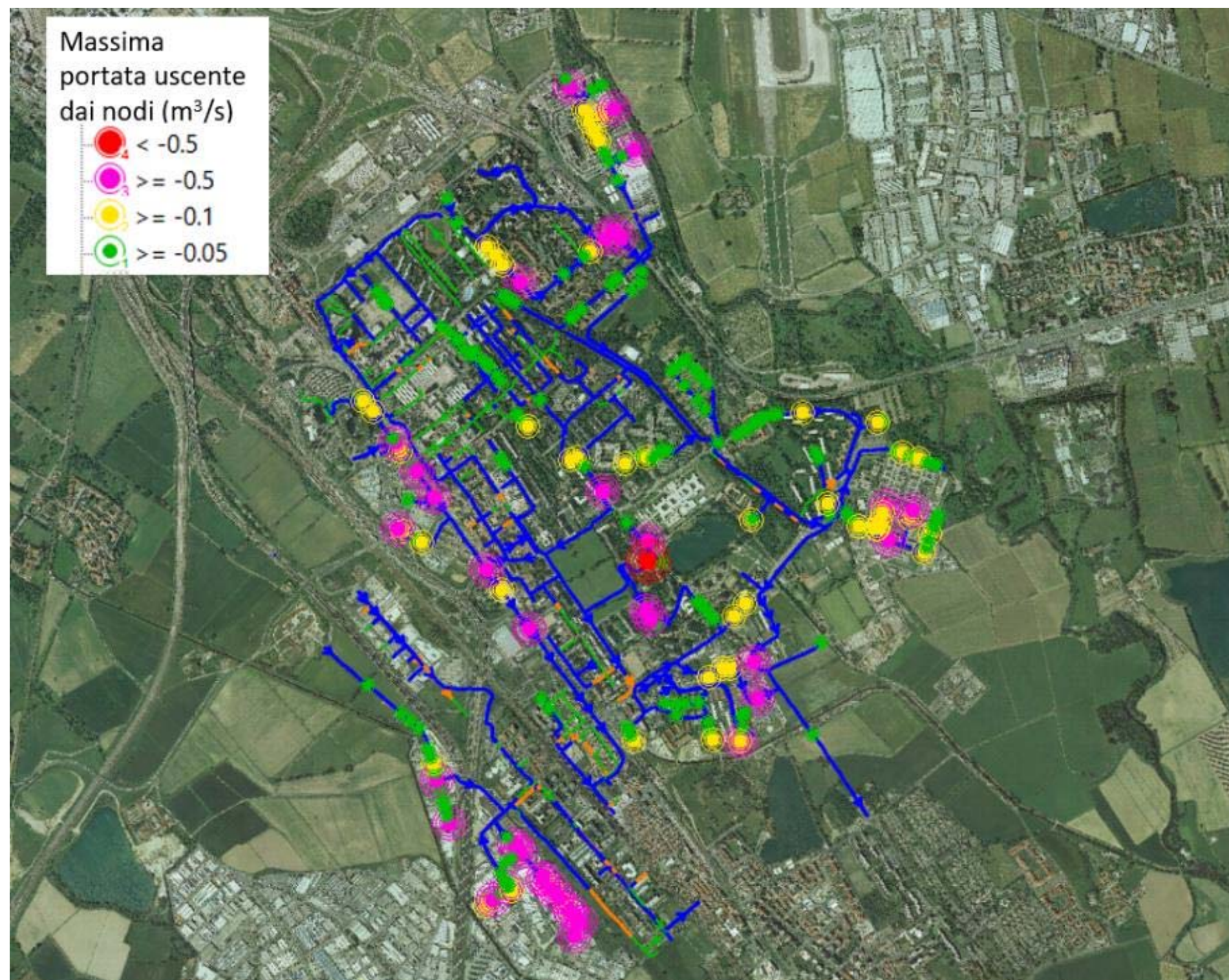
Figura 7.13 – Portata massima uscente dai nodi T10 San Donato Est
