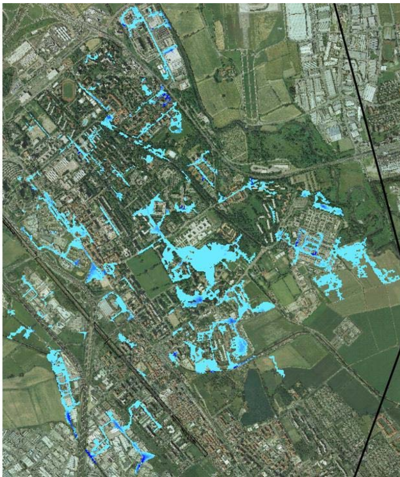
Figura 7.25 – Allagamenti stato di fatto T100 San Donato Est
