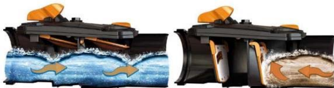
Figura 8.45 - Funzionamento del sistema antiriflusso
