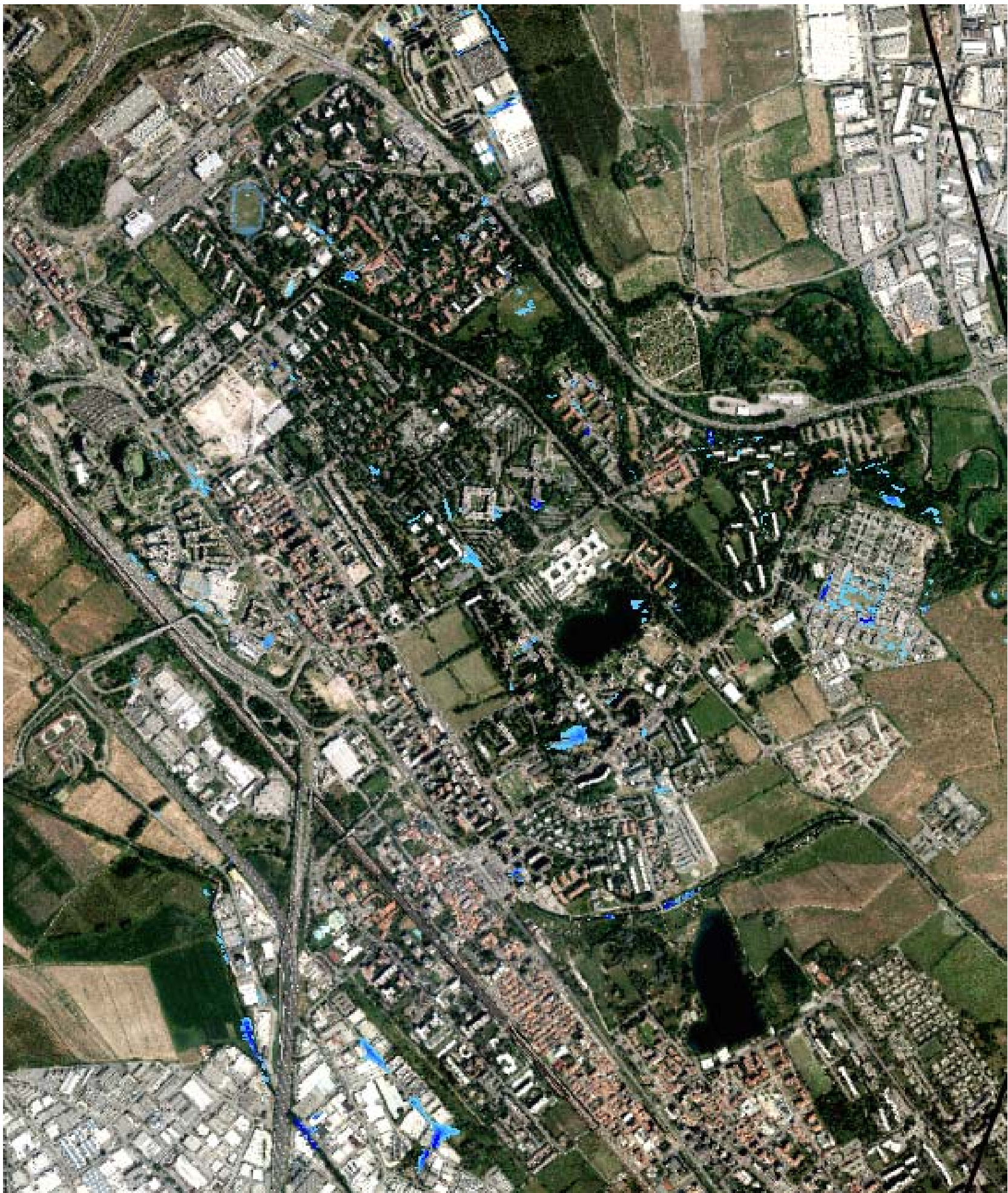
Figura 8.32 – planimetria degli allagamenti T=100 anni assetto di progetto– Scenario 2
