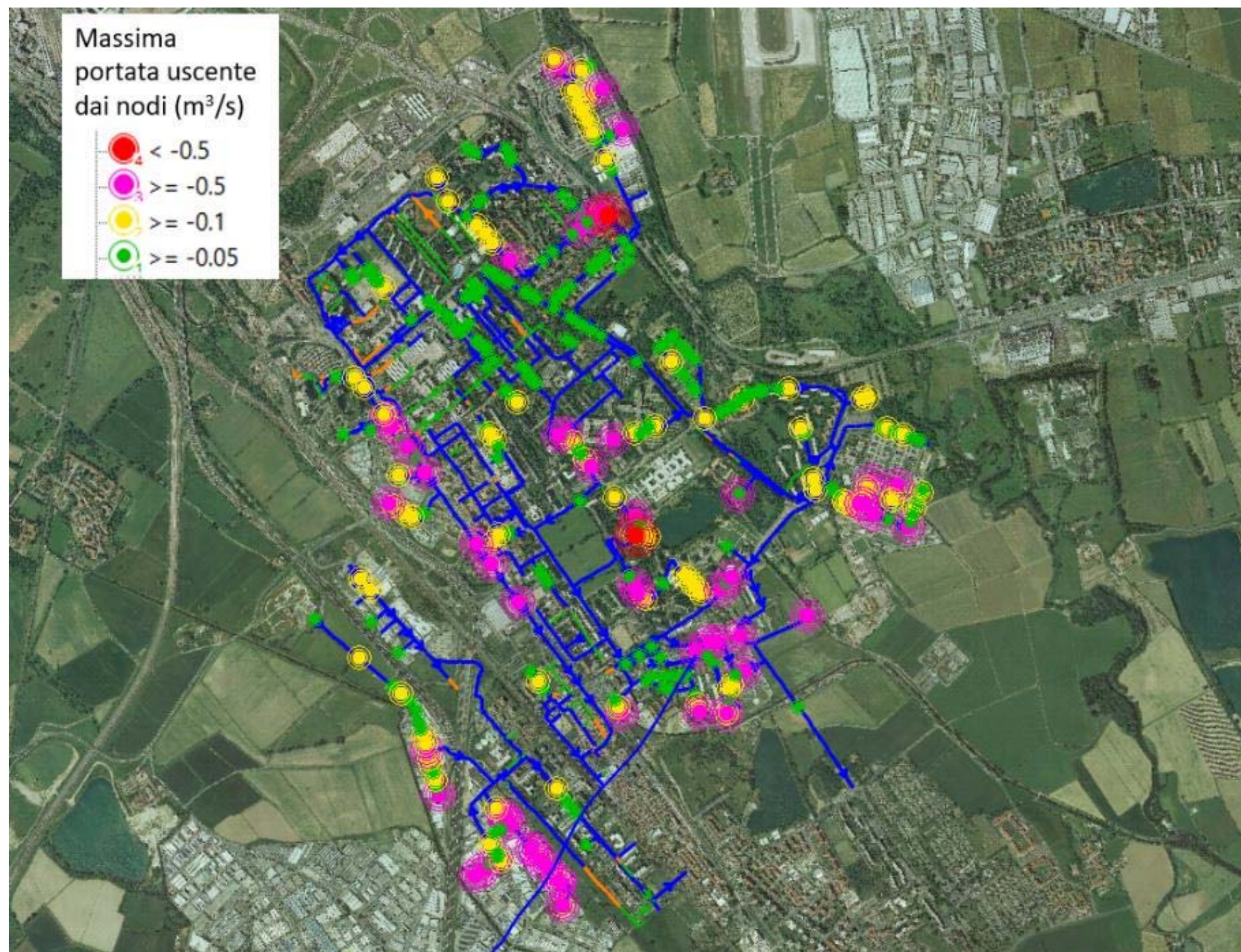
Figura 7.14 – Portata massima uscente dai nodi T50 San Donato Est
