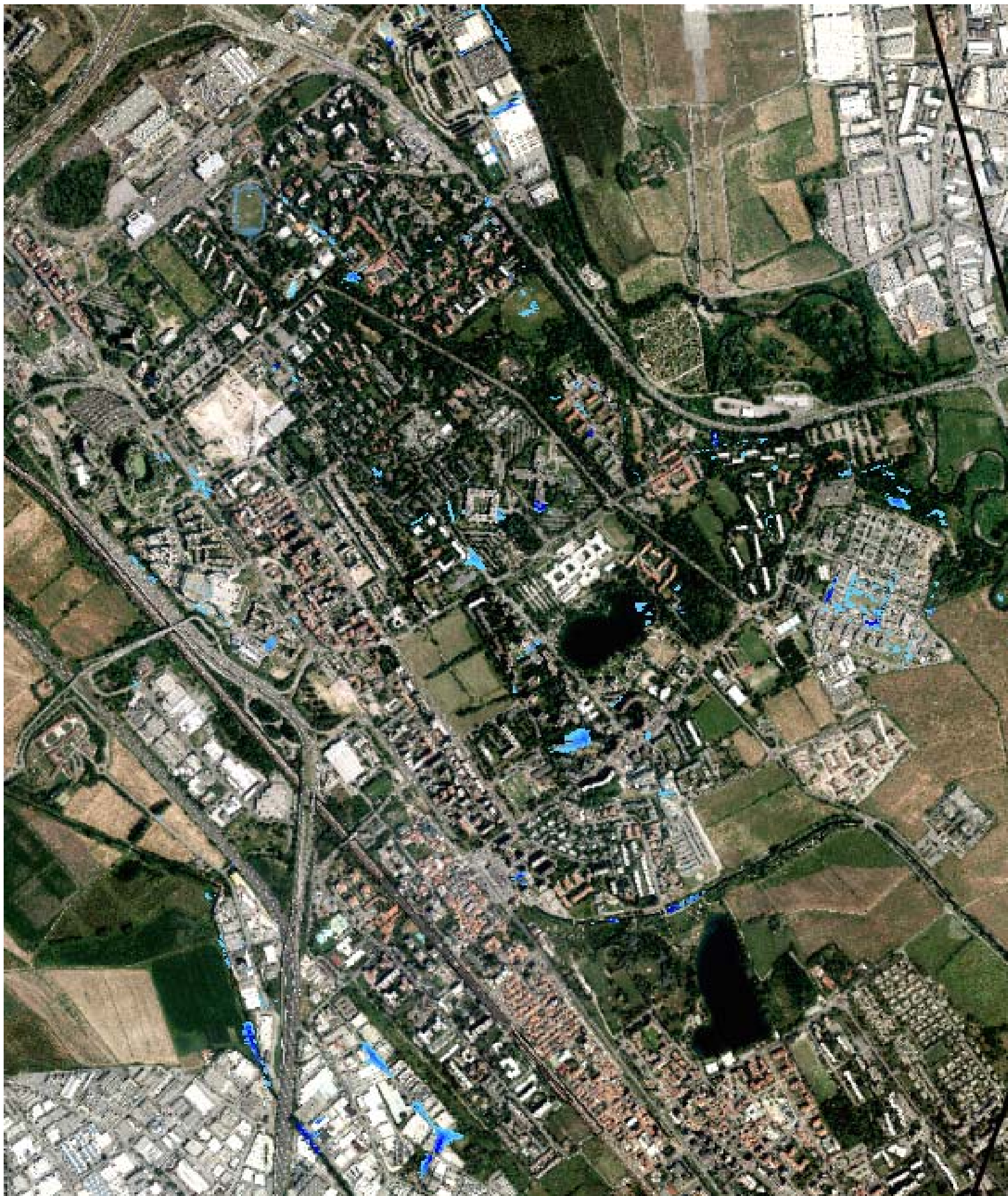
Figura 8.30 – planimetria degli allagamenti T=50 anni assetto di progetto– Scenario 2
