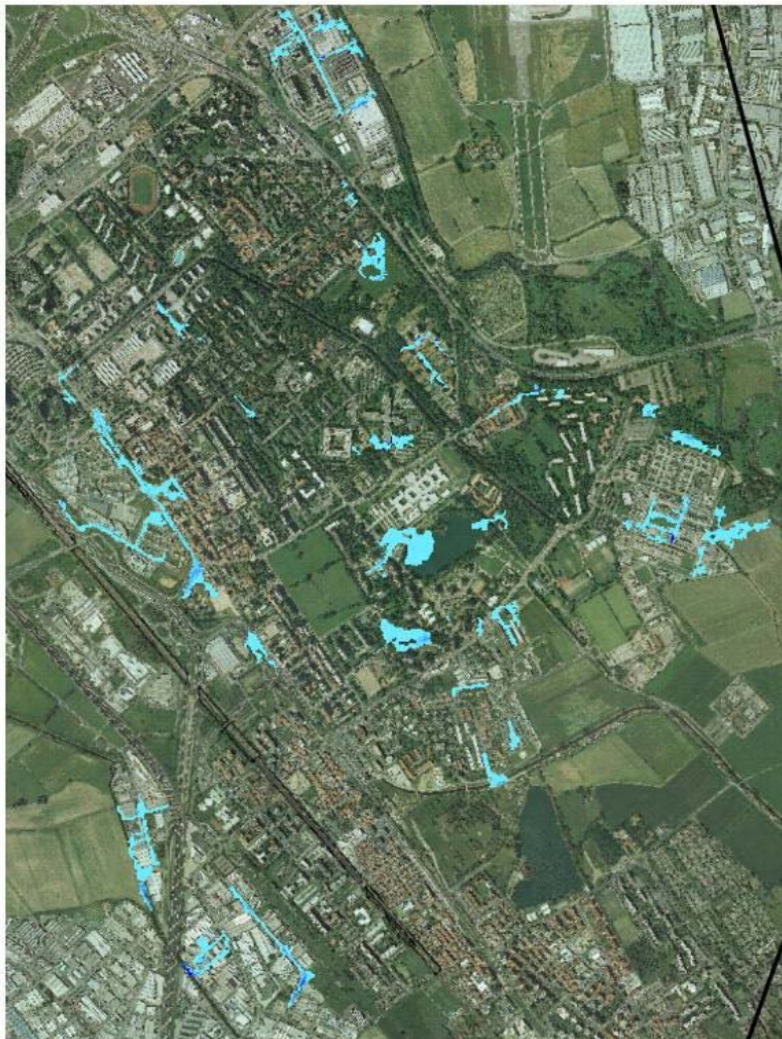
Figura 7.21 – Allagamenti stato di fatto T2 San Donato Est
