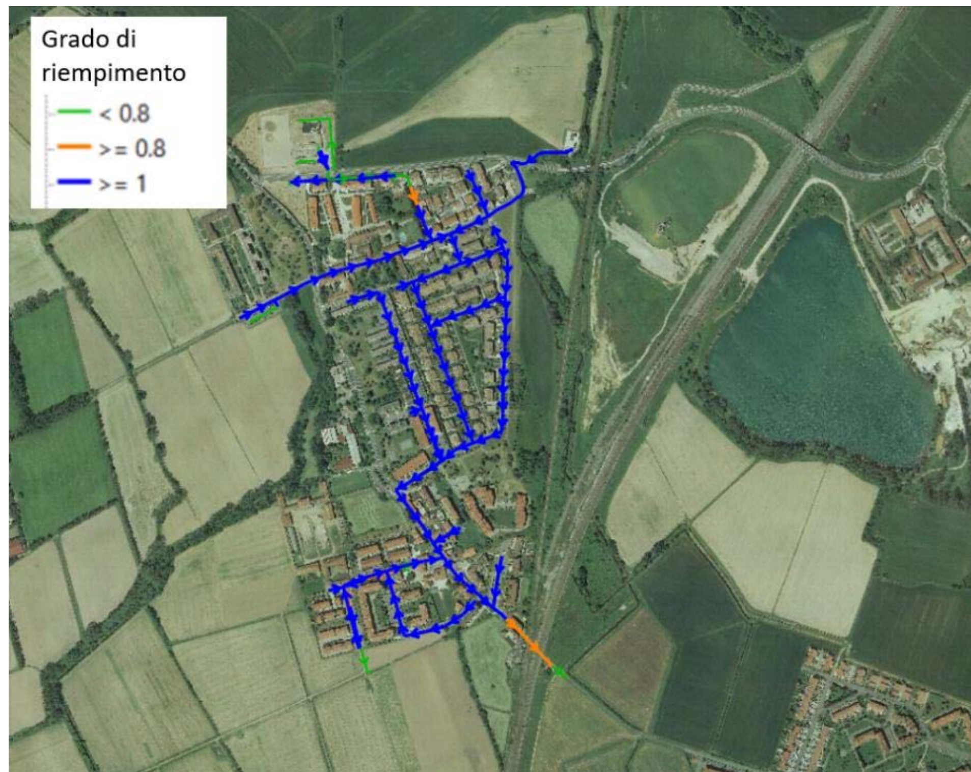
Figura 7.6 – Visuale massima criticità Tr=2 anni San Donato Ovest
