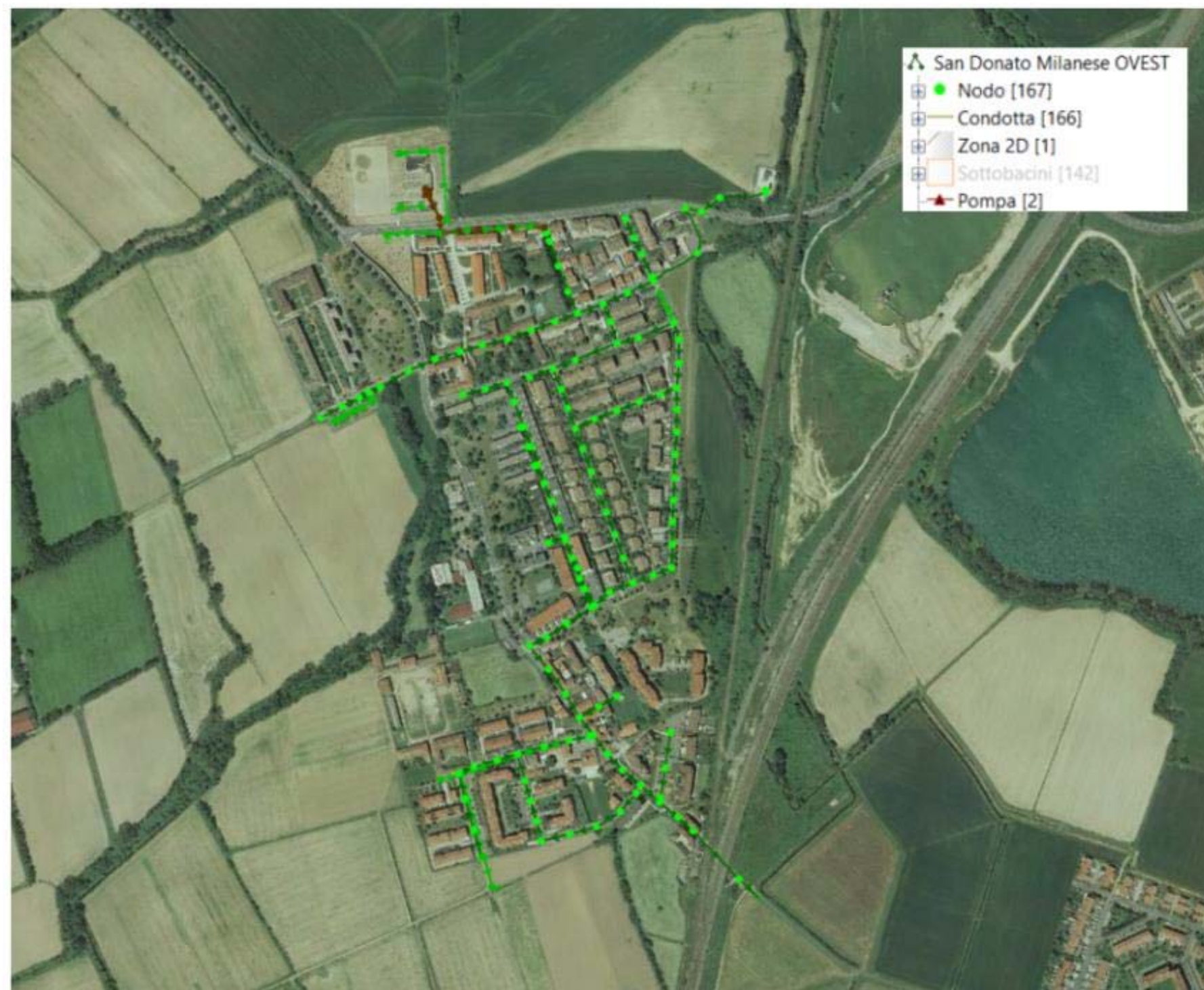
Figura 5.2 - Geometria rete fognaria di San Donato OVEST
