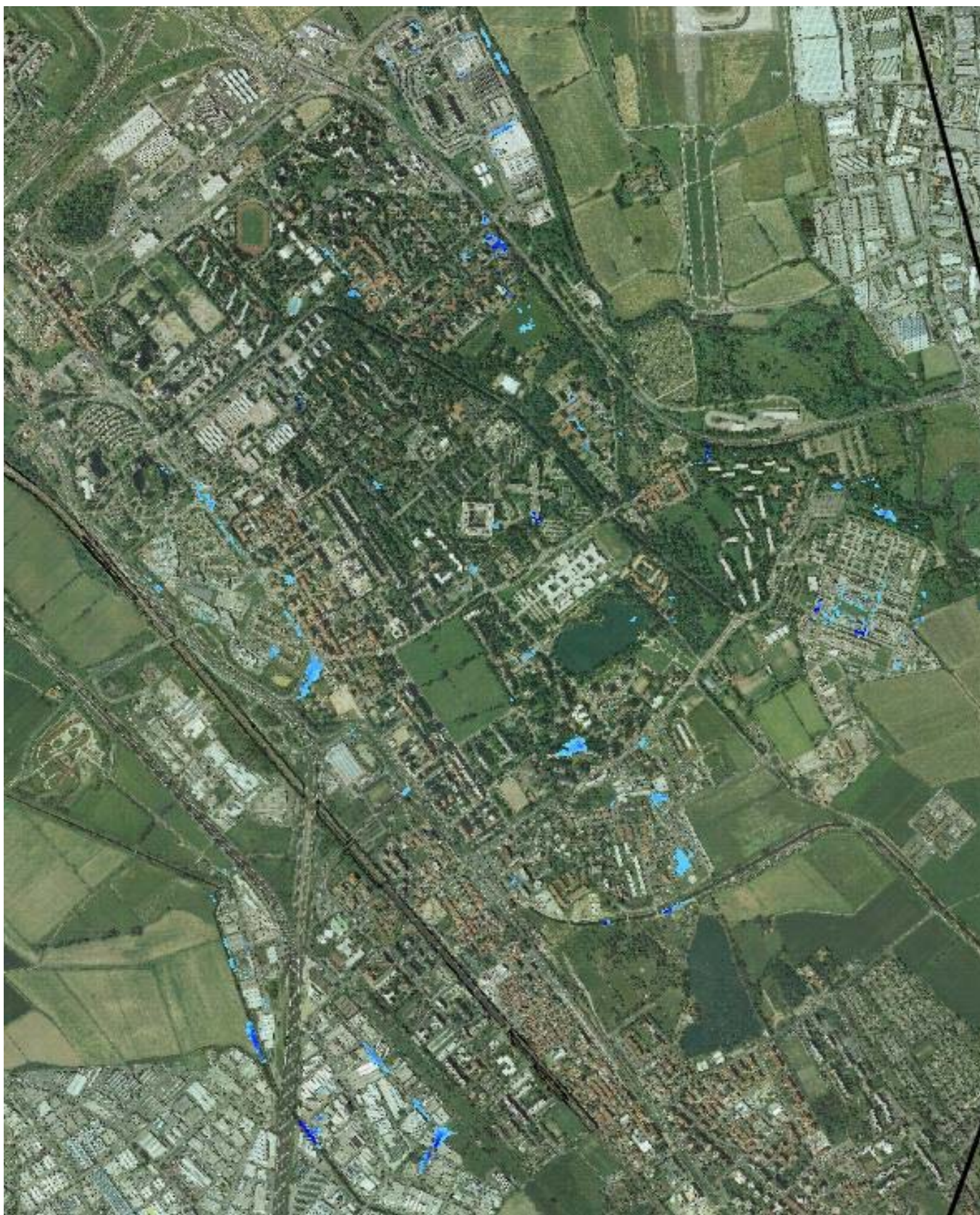
Figura 8.27 – planimetria degli allagamenti T=10 anni stato di fatto
