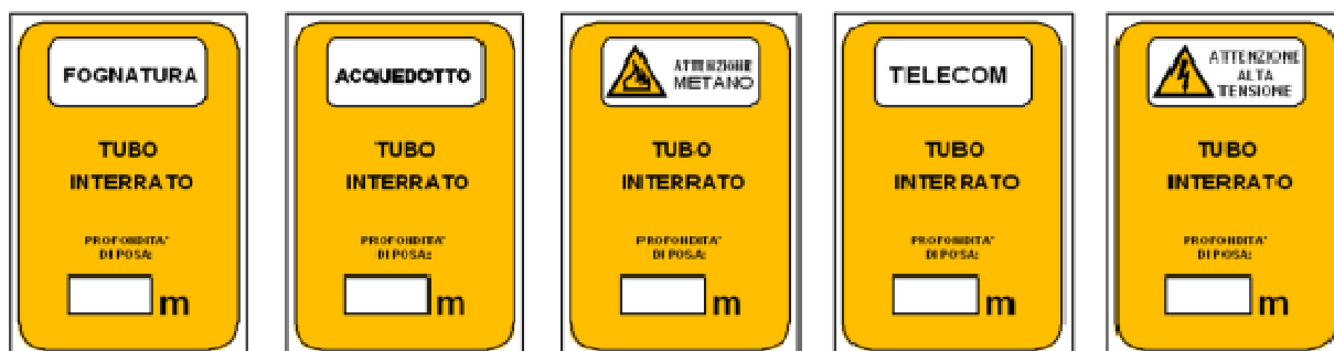
Cartellonistica per identificazione delle linee interrato
