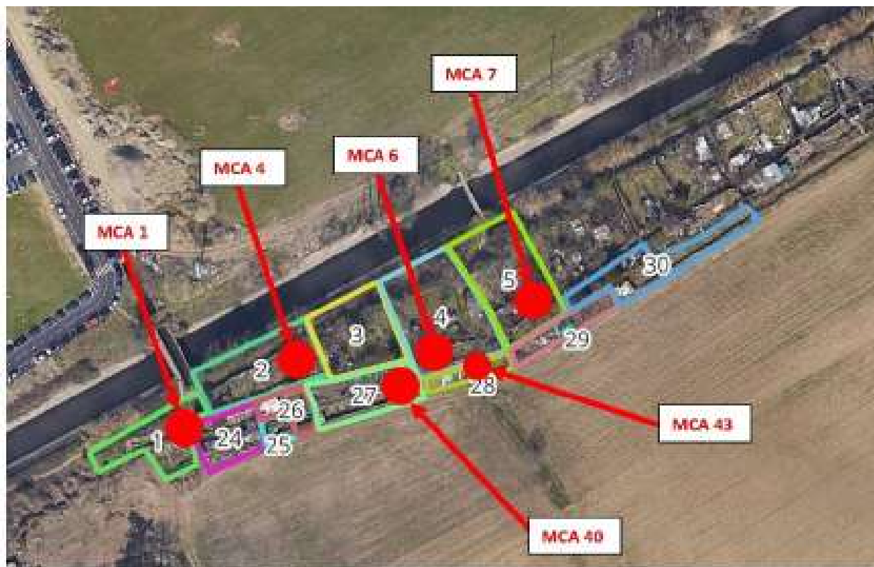
Figura 4 - Lotti con materiali contenente amianto
