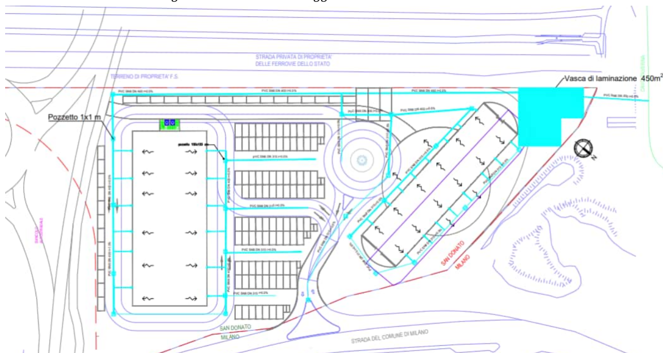
Figura 2-10 – Rete di drenaggio con Vasca di Laminazione
